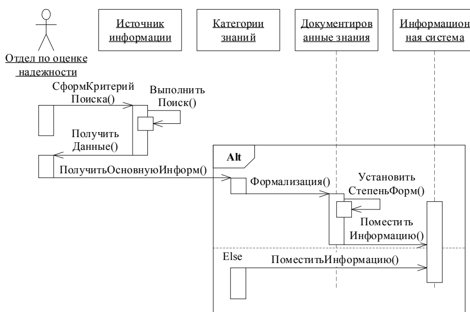
Рис. 4. Модель временного взаимодействия экземпляров классов, представленная с помощью UML диаграммы последовательности
